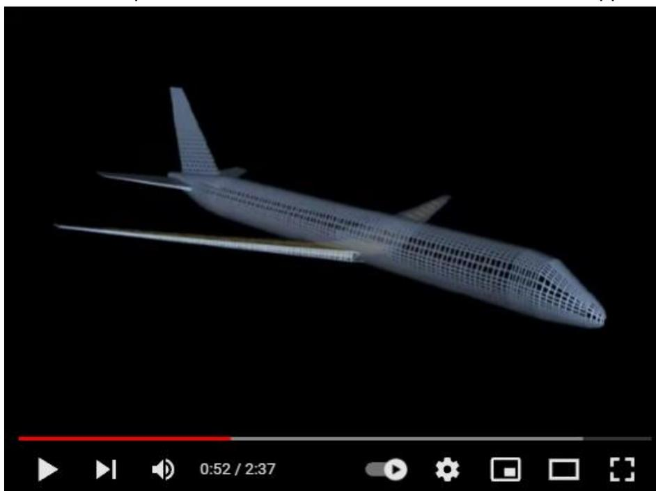
... Tu les vois les réacteurs ? Pas moi... pourtant ce sont de très loin les éléments les plus denses et les plus durs de l'avion. Malgré ça, ils ne les ont pas intégrés : ils ont modélisé un avion sans réacteur !
